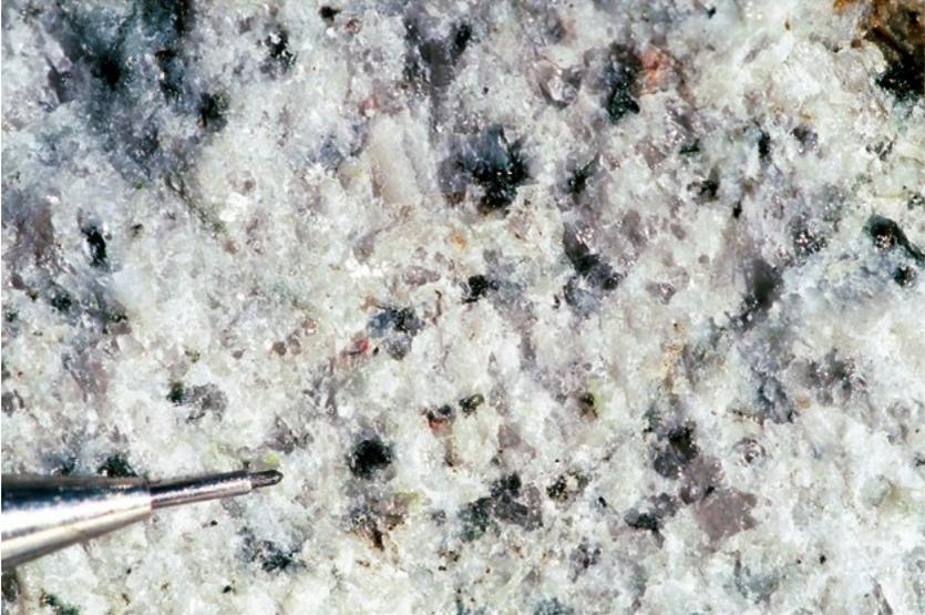
Fig. 30: Detailaufnahme des Bristen-Granits. Handstück aus dem Gotthard-Basistunnel.
