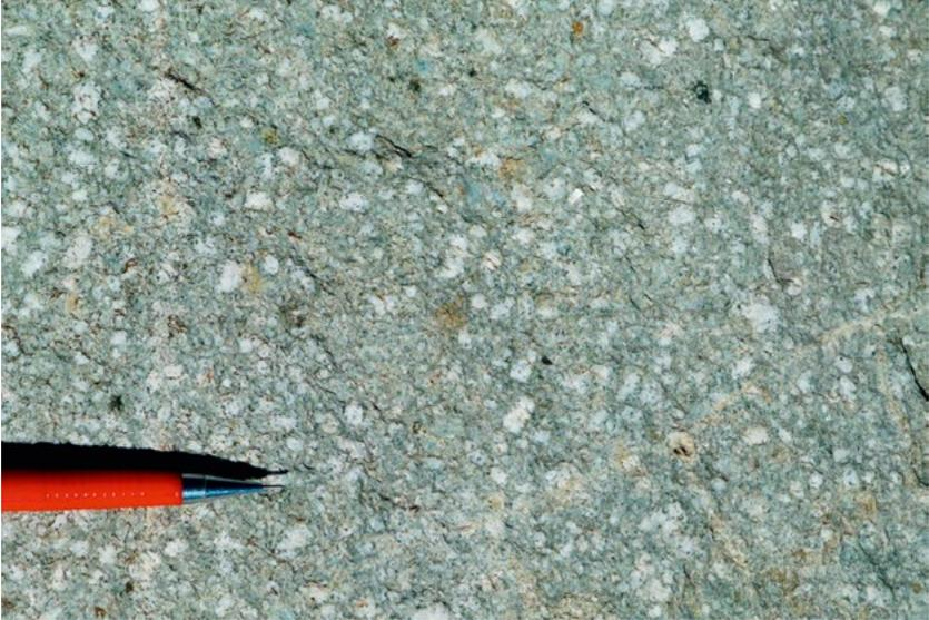
Fig. 7: Detailaufnahme einer angewitterten Oberfläche des porphyrischen Biotit-Plagioklasgneises (Straligenstöckli-Gneiskomplex). Val Gronda da Cavrein (Koord. 2706.800/1182.000). Foto C. Gisler.
