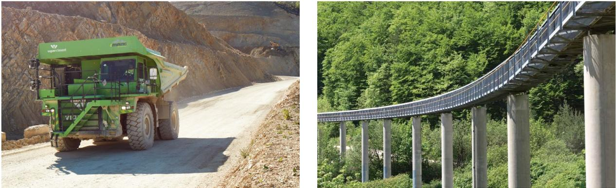
**Fig. 13:** Elektrisch betriebener Dumper (links) und Förderband (rechts) beim Zementwerk in Péry.
