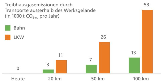
**Fig. 27:** Treibhausgasemissionen durch den Transport von primären Zementrohstoffen über 20, 50 und 100 km per Bahn und LKW [25].
