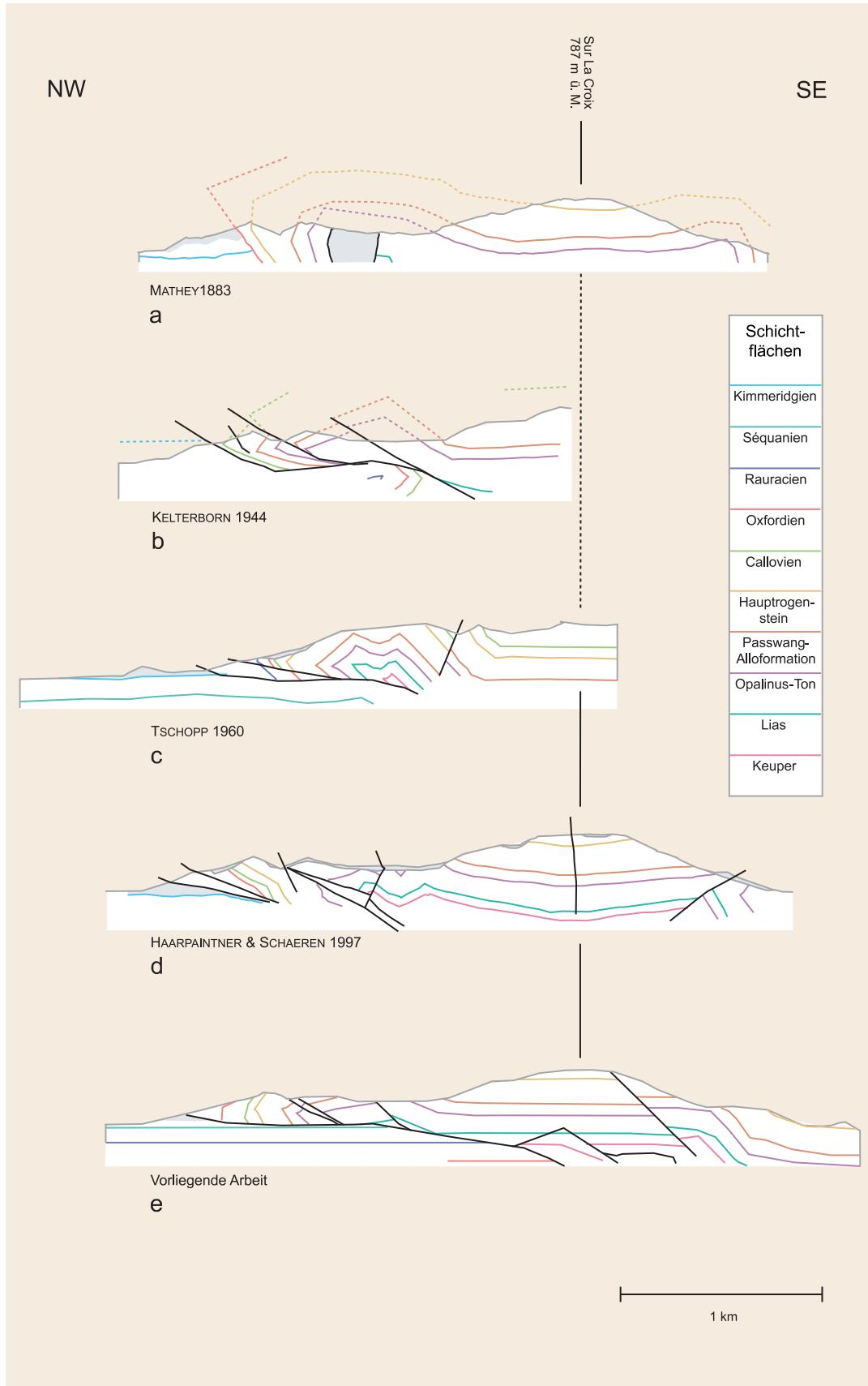
Abb. 1: Zusammstellung der geologischen Profile entlang dem Eisenbahn-tunnel La Croix (vgl. Kap. 3.3.3). Abb. z.T. verändert aus den angegebenen Referenzen. Die grau gerasterten Flächen bezeichnen nicht weiter differenzierte Gesteinsmassen (tertiäre und quartäre Ablagerungen, tektonische Brekzien).
