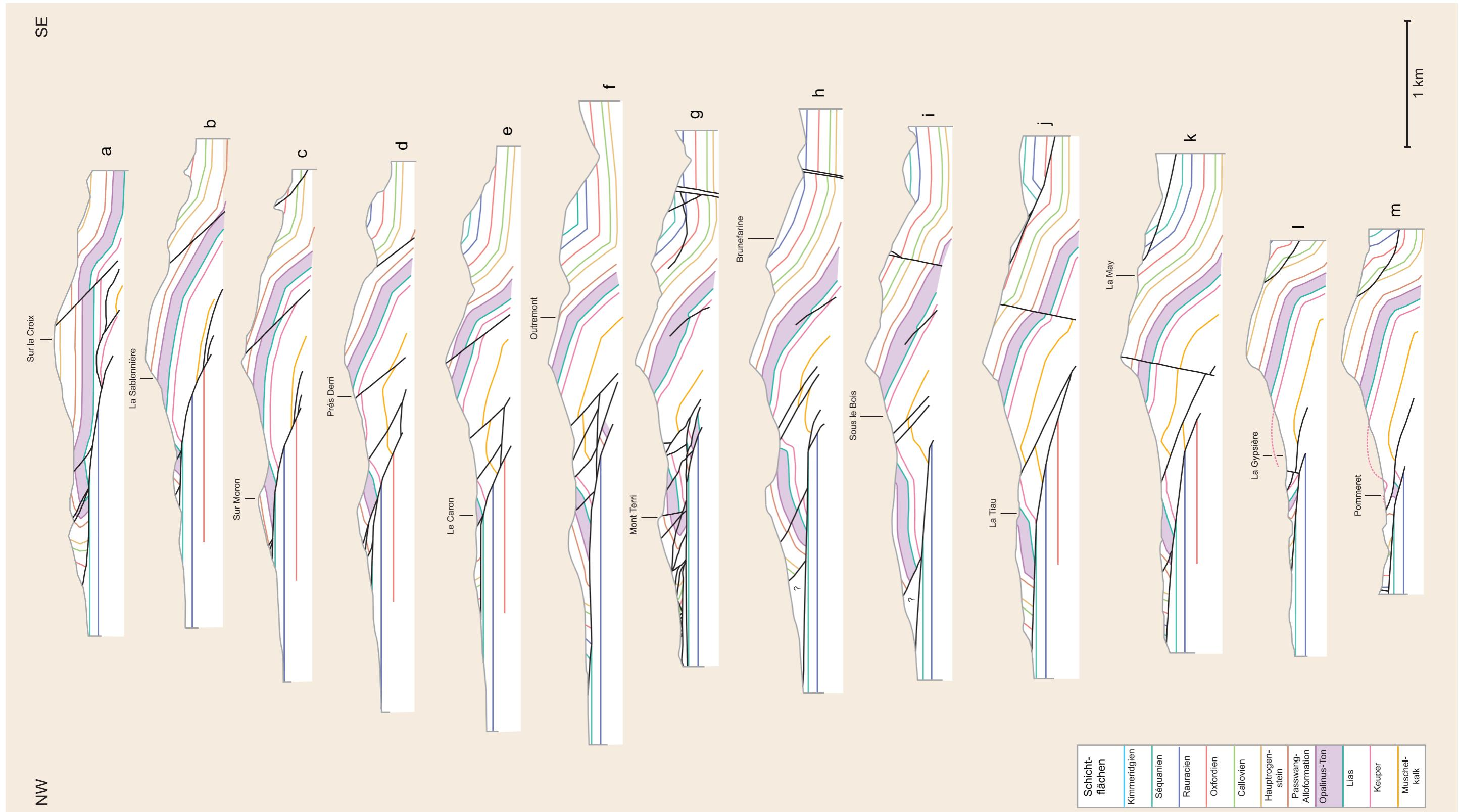
Abb. 15: Profilserie durch die Mont-Terri-Antiklinale. Vgl. Kap. 3.4. In Schwarz: Brüche. Die Profilspuren sind aus Abb. 7 ersichtlich.
