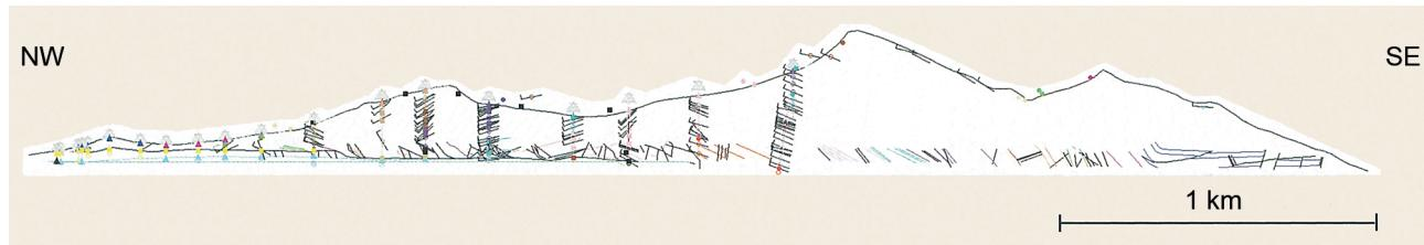
Abb. 10: Zusammenstellung der für die Bilanzierung des Profils Mont Terri verwendeten Daten. Enthalten ist die Kartierung des Tunnels (BTN 1994a) sowie Informationen aus den Bohrungen (BGA 1988) und der Oberflächenkartierung (KOHLER 2000), die in die Profilebene projiziert werden. Lithologien sind farbcodiert, die Art der Oberfläche ist formcodiert, das scheinbare Einfallen ist durch Fallzeichen dargestellt. Vgl. Abb. 13.
