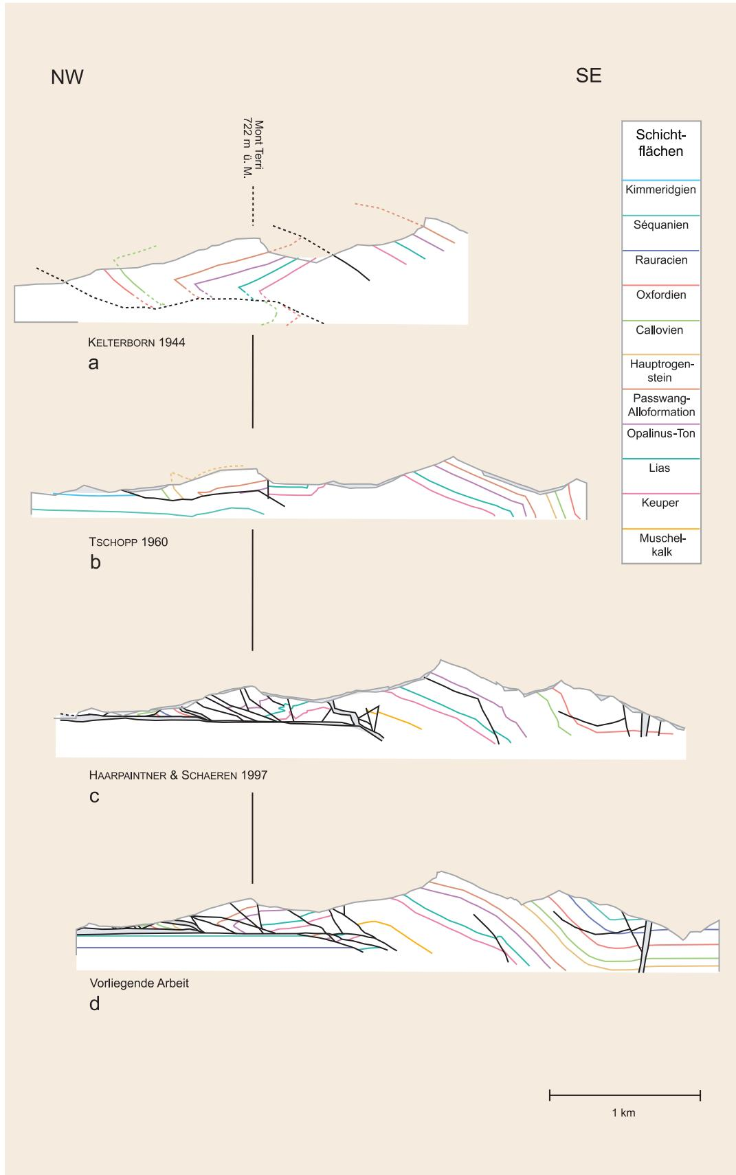
Abb. 2: Zusammensetzung der geologischen Profile nahe des Autobahntunnels Mont Terri (vgl. Kap. 3.2.3). Abb. z.T. verändert aus den angegebenen Referenzen. Die grau gerasterten Flächen bezeichnen nicht weiter differenzierte Gesteinsmassen (tertiäre und quartäre Ablagerungen, tektonische Brekzien).
