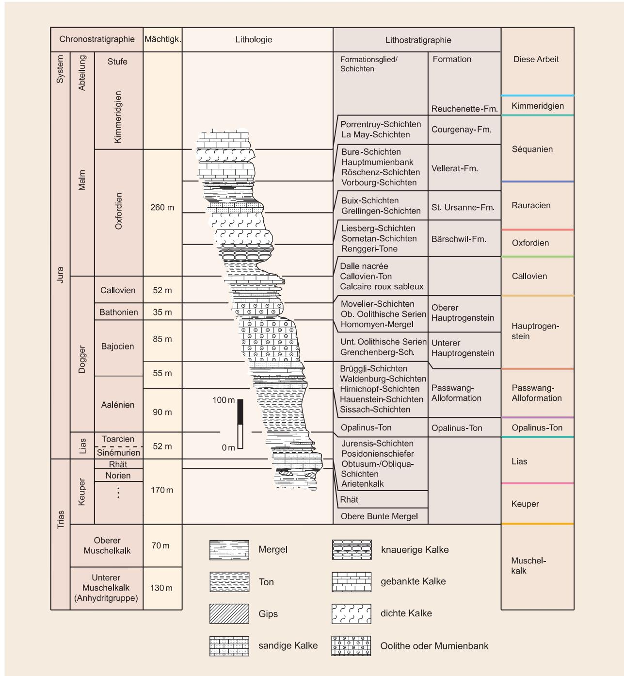
Abb. 9: Stratigraphisches Profil. Zusammengestellt aus BTN (1994a, 1994b), BURKHALTER (1996), GYGI (2000) und LAUBSCHER (1963).
