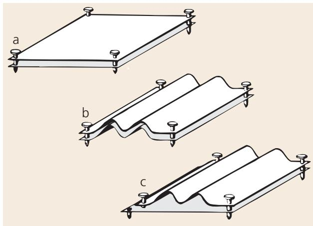
Abb. 3: Die Schichtlängenkonsistenz. Schichtlängen im undeforinierten (a) und im deformierten Zustand (b) sind, auf zwei Pinlines bezogen, gleich lang. Tritt ein Bruch oder ein Décollement auf, so dass eine Pinline zerschnitten wird (c), so muss der Versatz quantifizierbar sein, um den Bezug zwischen den Pinlines zu wahren. Verändert aus DAHLSTROM (1969).
