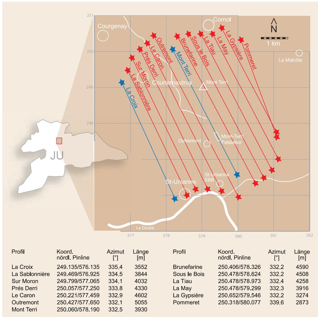
Abb. 7: Die Lage des Arbeitsgebietes. In blau: die Profilspuren der bilanzierten Profile. In rot: die Spuren der nicht bilanzierten Profile (vgl. Kap. 3.4 und Abb. 15). Aus der Tabelle ist die genaue Georeferenzierung der Spuren ersichtlich.
