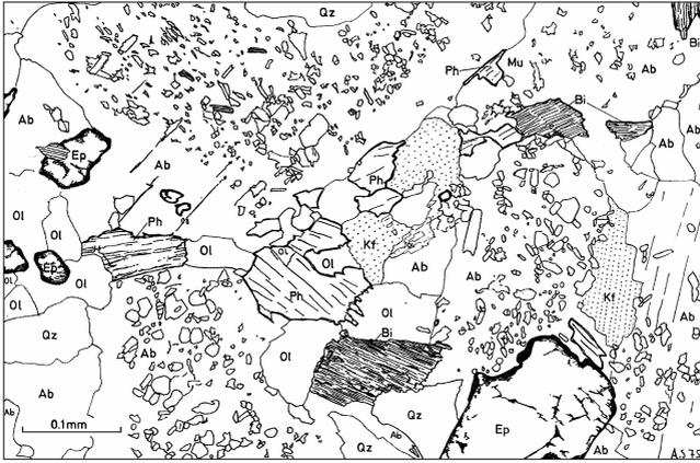
Fig. 13: Dünnschliffzeichnung einer alpin undeformierten Rotondogranit-Probe.
