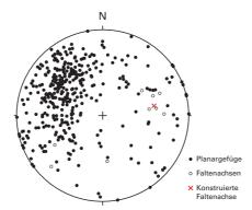
Fig. 13: Orientierung der Planar- und Lineargefüge von Scholleneinschlüssen im Innertkirchen-Kristallin. Schmidt'sches Netz, untere Halbkugel. Planare Elemente als Flächenpole, lineare als Durchstichpunkte.
