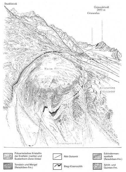
Fig. 26: Profilansicht der eingefalteten mesozoischen Sedimente am Chalchberg westlich von Färnigen (aus Alb. Heim & Arn. Heim 1916).
