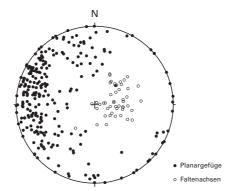
Fig. 6: Orientierung der ordovizischen Planar- (Bänderung) und Lineargefüge (Faltenachsen) im Erstfeld-Gneis im Gebiet Triftgletscher-Giglistock-Steilimigletscher-Umpol-In Hublen-Sustenspitz. Schmidt'sches Netz, untere Halbkugel. Planare Elemente als Flächenpole, lineare als Durchstichpunkte.
