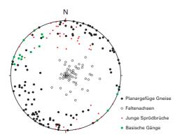
Fig. 57: Überlagerung ordovizischer, variszischer und alpiner Strukturen der Erstfeld-Zone entlang der Sustenpassstrasse westlich der Passhöhe: Ordovizisch steilachsig verfalteter Erstfeld-Gneis, durchsetzt von variszischen basischen Gängen, wird überprägt durch jüngere spröde, generell West-Ost verlaufende Scherzonen variszischen und/oder alpinen Alters. Schmidt'sches Netz, untere Halbkugel. Planare Elemente als Flächenpole, lineare als Durchstichpunkte.
