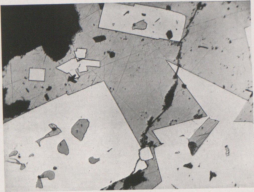
Fig. 8. Idiomorphe Pyritkristalle (weiss) mit Schapbachit (hellgrau). Innerhalb der Pyrite allotriomorphe Interpositionen von Hessit. 200 $\times$ , Gondo.
