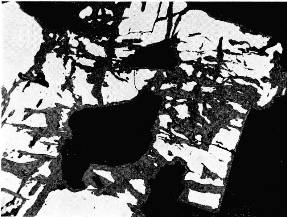
Fig. 2. Verwitterung des Pyrits unter Brauneisenbildung. Deutlich ist zu erkennen, wie die oxydative Verdrängung von Pyrit längs würfelfigen Spaltrissen stattfindet. 180  $\times$ , Gondo.
