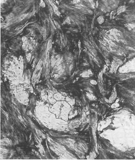
Fig. 1. Gefälte Faserbündel von Sillimanit aus grösserem Einschluss, durchsetzt von Quarz (weiss) und reichlich Apatit (grau mit höherem Relief). Vergr. 30fach.
