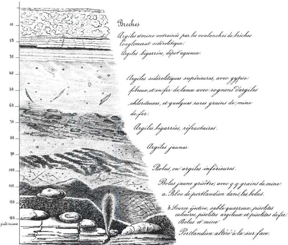
Abb. 3: Geologisches Profil einer ca. 45 m tiefen Eisenmine von Corcelon (heute Courcelon) bei Delémont. Aufgenommen, gezeichnet und publiziert von A. Quiquerez (1852). Das Bohnerz findet sich ganz unten, unmittelbar über dem Portland-Kalk. Mit Ausnahme der «source éjective» (b) würde man das Profil heute noch ganz ähnlich zeichnen. Die Gesteinsschichten zwischen 130 und 90 Fuss entsprechen der Bohnerzformation (Eozän), jene darüber gehören zur «Gelberde» (Oligozän).
