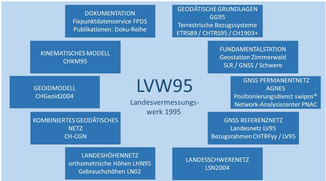
Abbildung 2-1: Schema der Komponenten des Landesvermessungswerkes LVW95
