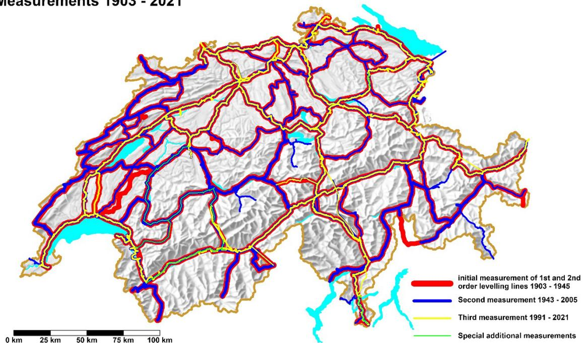
Figure 2-29 : mesures effectuées dans le réseau altimétrique national entre 1903 et 2021
