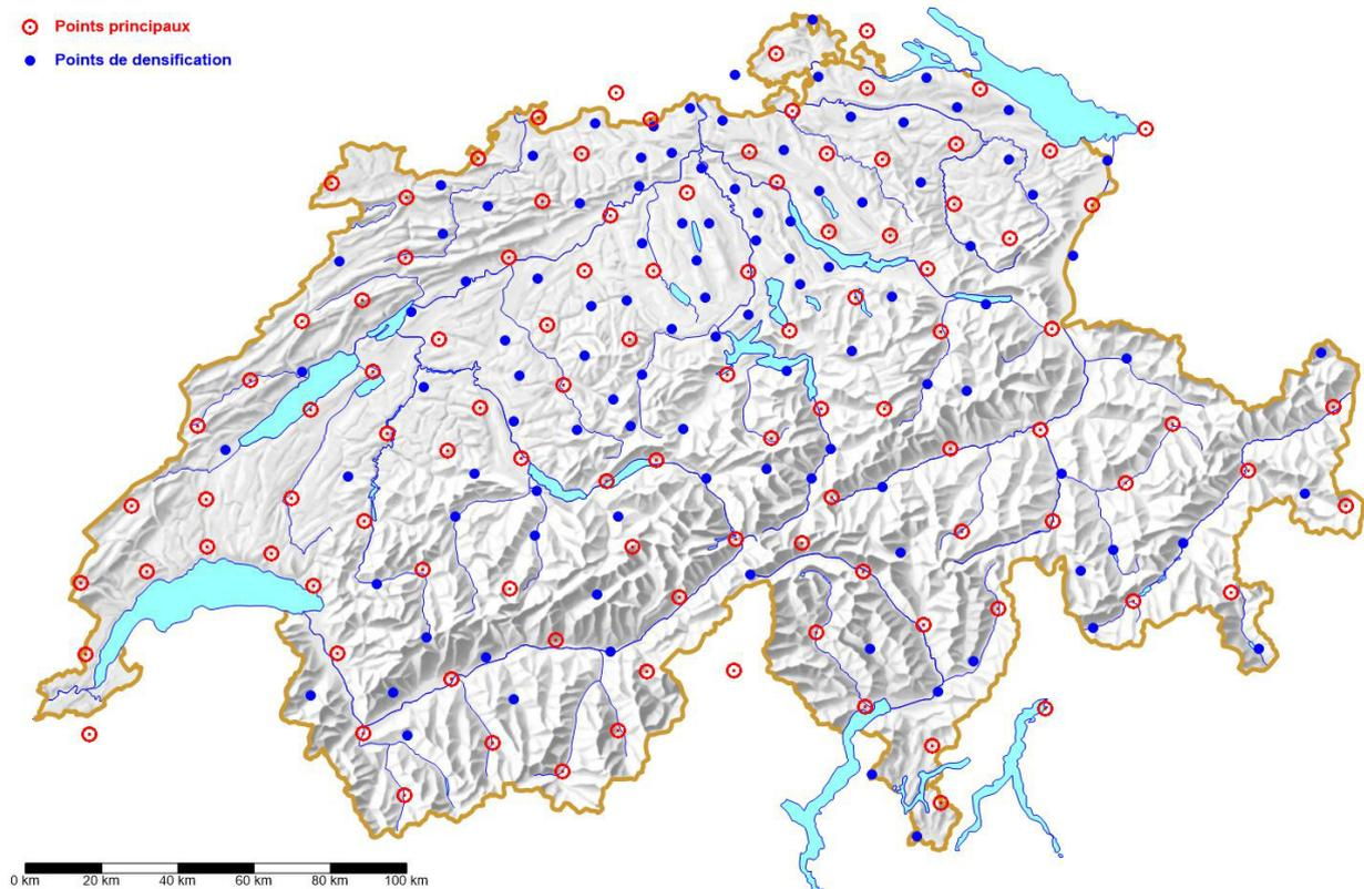
Figure 2-15 : vue d'ensemble des points du réseau de référence GNSS MN95
