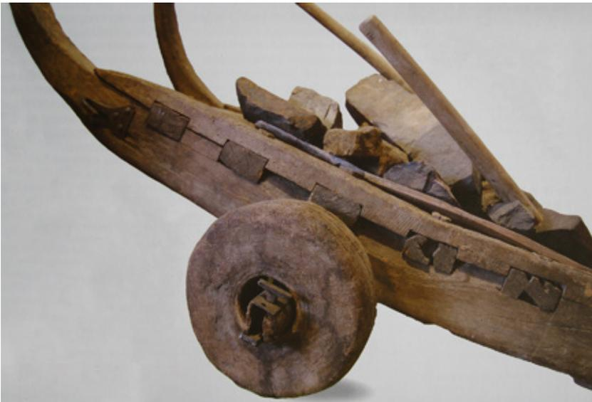
Fig. 80: Erhalten gebliebener originaler Erzschlitten aus dem Museum der Landschaft Hasli. Mit solchen Erzschlitten wurde das Eisenerz von den Gruben (Planplatten, Balmeregghorn, Ärzegg) über die steilen Wege hinunter ins Gental transportiert, wo es nach dem Rösten mit Pferdewagen bis zum Ausgang des Gentals geführt und anschliessend nochmals mittels Schlitten zum Hüttenwerk Mühletal geschlittelt wurde. Foto R. Widmer, 2016 (aus WENGER et al. 2016).
