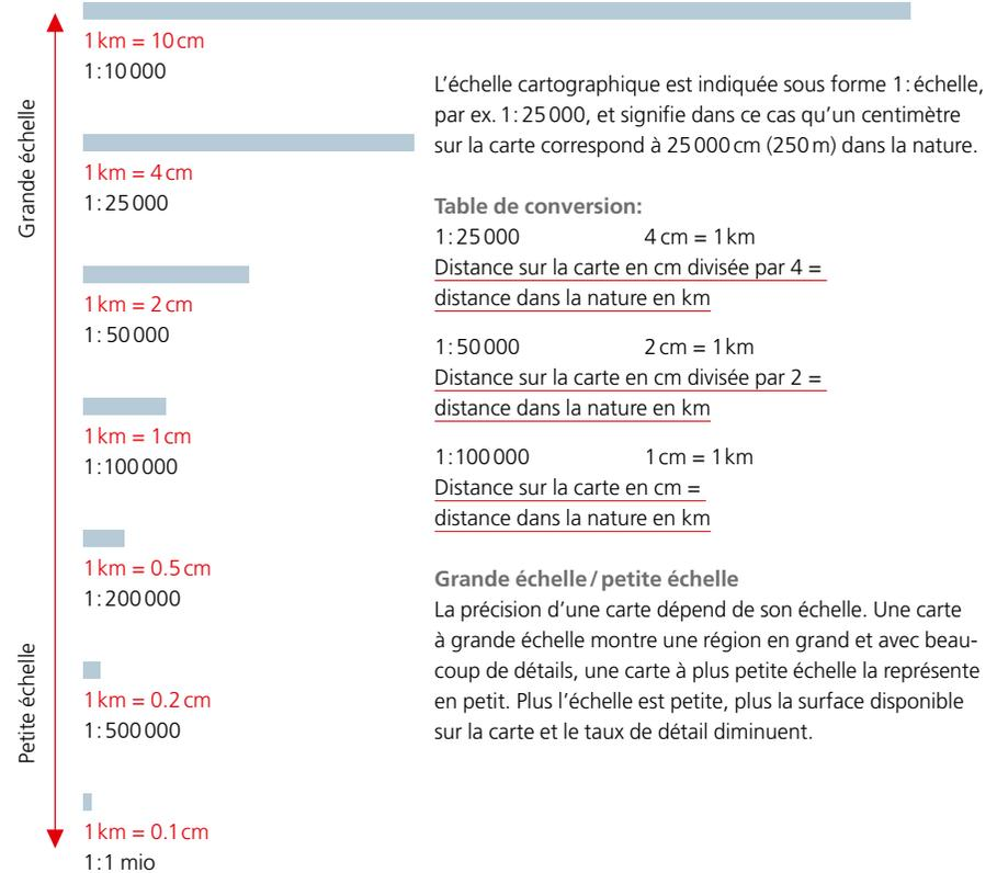
L'échelle cartographique est indiquée sous forme 1: échelle, par ex. 1: 25 000, et signifie dans ce cas qu'un centimètre sur la carte correspond à 25 000 cm (250 m) dans la nature.
