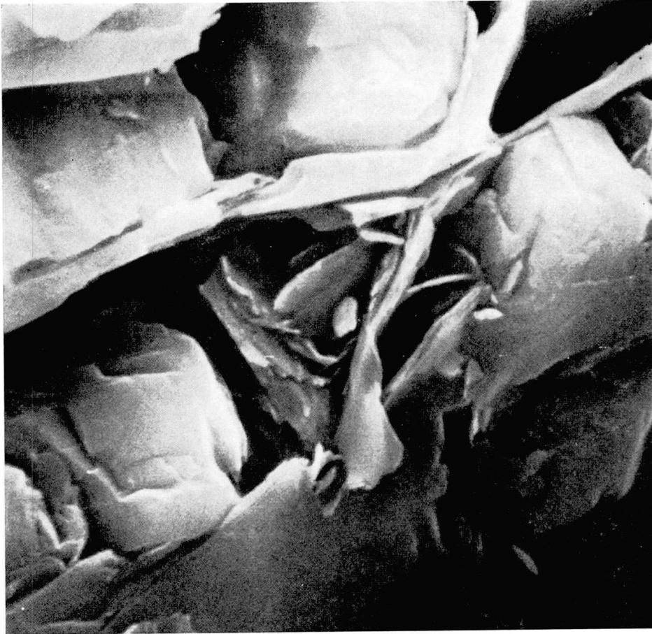
Fig. 7. Ausschnitt des Opalinuston-Aggregates. Raster-Elektronenmikroskop, 10 000 fach.
