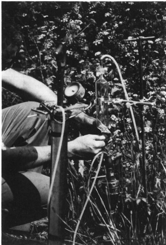
Fig. 5: Bodengas-Entnahme an einem Messpunkt.
