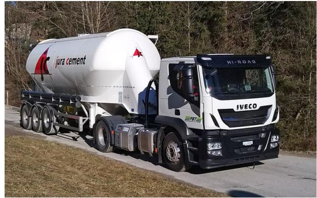
**Fig. 15:** À gauche: train entier composé de wagons-silos de 65 tonnes. À droite: camion-silo de 28 tonnes. Sources des photos: Holcim (Suisse) SA (à gauche) et JURA Materials (à droite).
