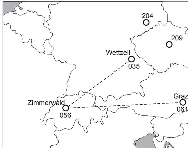
**Figure 4.2-1: Rattachement du réseau GPS MN95 avec les 'fiducial stations ITRS' et avec le réseau européen EUREF**
