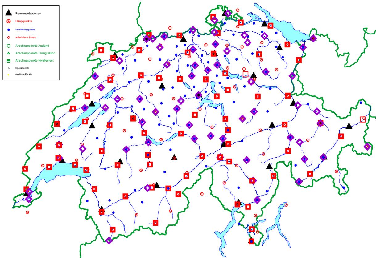
**Abb. 4.3-1:** GPS-Netz LV95 mit Anschlusspunkten ans Landesnivellement (horizontale Quadrate: Stützpunkte in CHGEO98, schräg gestellte Quadrate: keine Stützpunkte in CHGEO98)
