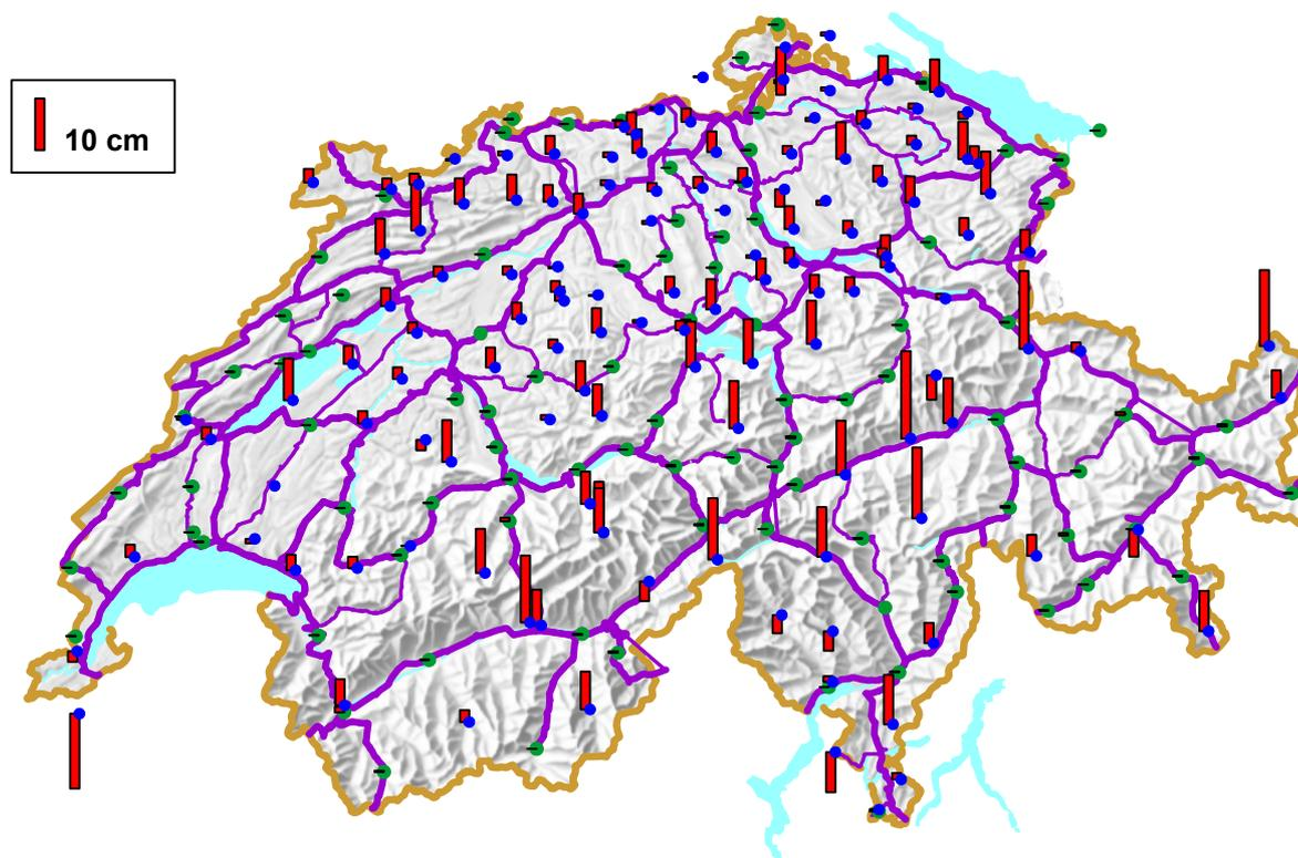
**Figure 8-6** : différences entre les altitudes usuelles NF02 existantes et transformées à l'aide de *HTRANS* sur les points MN95 et les stations AGNES ; points verts : points d'appui de la transformation ; points bleus : pas de lien avec RAN
