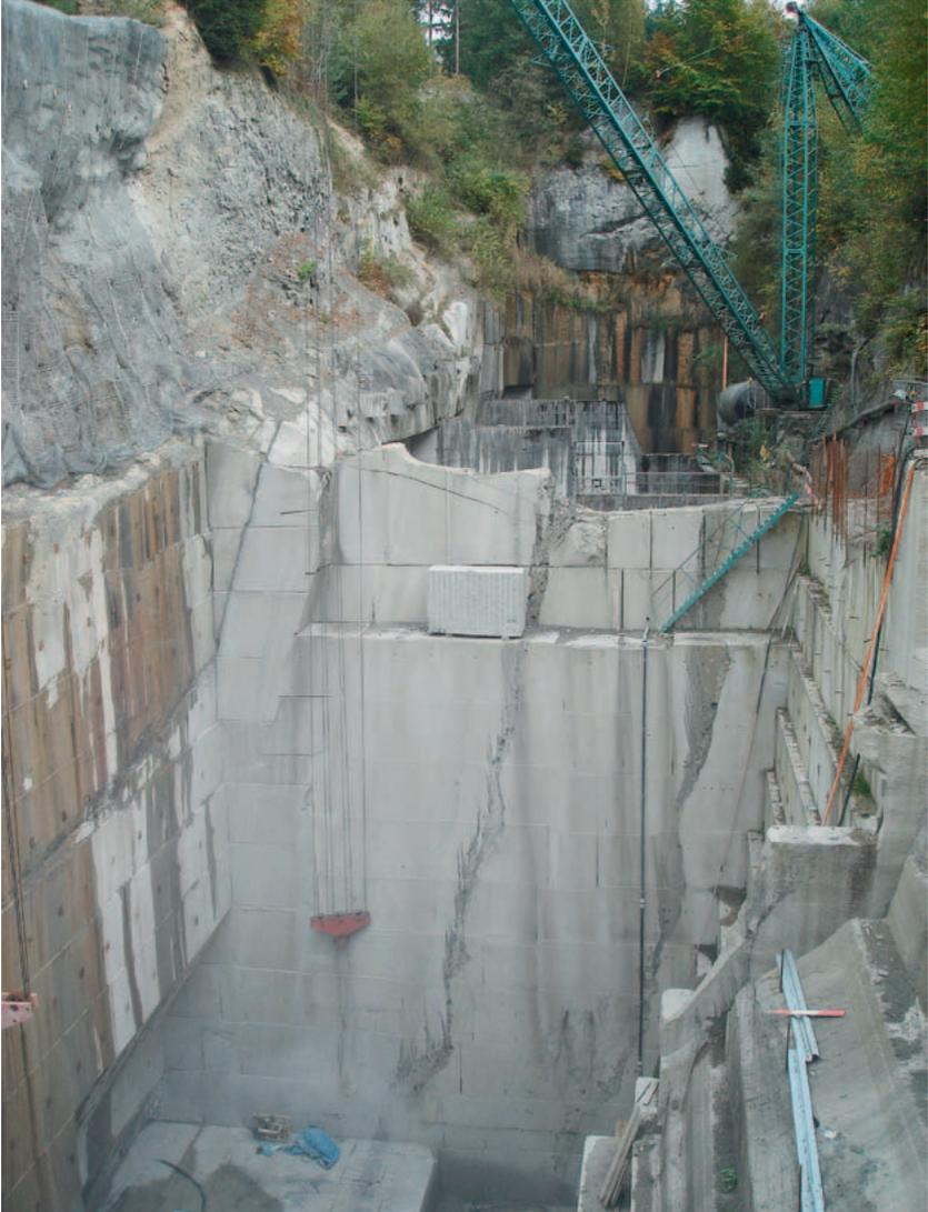
Fig. 24: Steinbruch Lehholz in der «Granitischen Molasse» östlich Wurmsbach bei Koord. 708.720/230.925. Erkennbar sind Einschaltungen von resedimentierten Molassemergeln innerhalb der sandigen Rinnengürtelablagerungen. Der auch unter dem Begriff «Bollinger-Sandstein» bekannte Sandstein wird heute noch abgebaut, z.T. bis unter Seeniveau. Foto: D. Kälin 2012.
