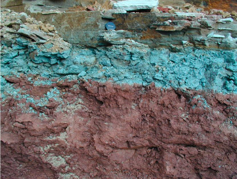
Fig. 3: «Röt», Dinkelberg-Formation (Buntsandstein). Baugrube des südlichen Brückenkopfs der Rheinfelder Autobahnbrücke (Koord. ca. 2624.100/1266.350). Foto H. Burger, 2003.
