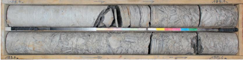
Fig. 4: «Obere Sulfatzone», Zeglingen-Formation («Anhydritgruppe»). Oben (188,0 – ca. 188,6 m) massiver bis geschichteter Anhydrit, unten (188,6–190,0 m) Anhydrit-Tonstein-Brekzie. Bohrung S154 Arisdorf der Schweizer Salinen AG (Koord. 2623.828/1262.449, s. S. 172). Foto via J. Pietsch.
