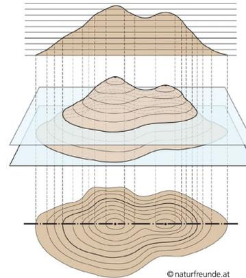
Höhenkurven sind Linien in der Karte, die Punkte mit gleicher Höhe verbinden. Der Höhenunterschied zwischen zwei benachbarten Höhenkurven wird als Äquidistanz bezeichnet.
