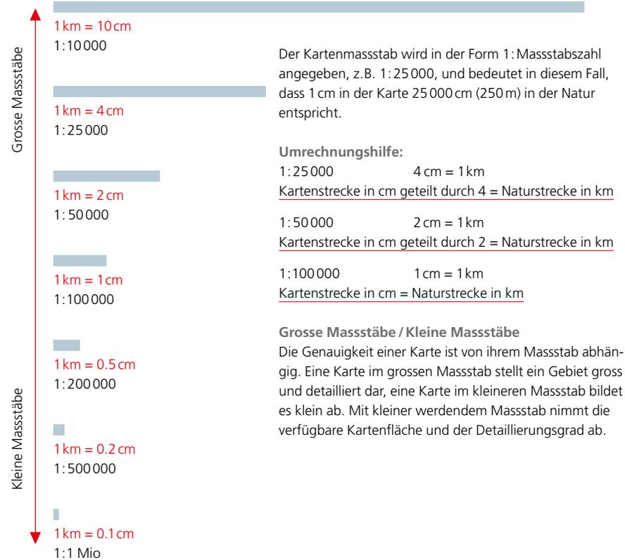
Der Kartenmassstab wird in der Form 1: Massstabszahl angegeben, z.B. 1:25 000, und bedeutet in diesem Fall, dass 1 cm in der Karte 25 000 cm (250 m) in der Natur entspricht.
