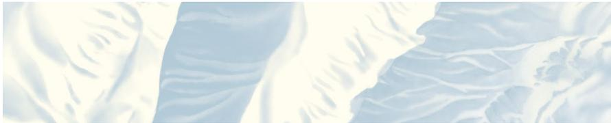
Die Beleuchtung für das Relief wird von links oben (Nordwest) angenommen. Dies entspricht zwar nicht der natürlichen Besonnung, dafür aber der Gewohnheit des Gehirns. Dieses ist sich gewohnt, dass das Licht von oben kommt. Mit einem hellen Gelb wird die Wirkung der Schattierung verstärkt.
