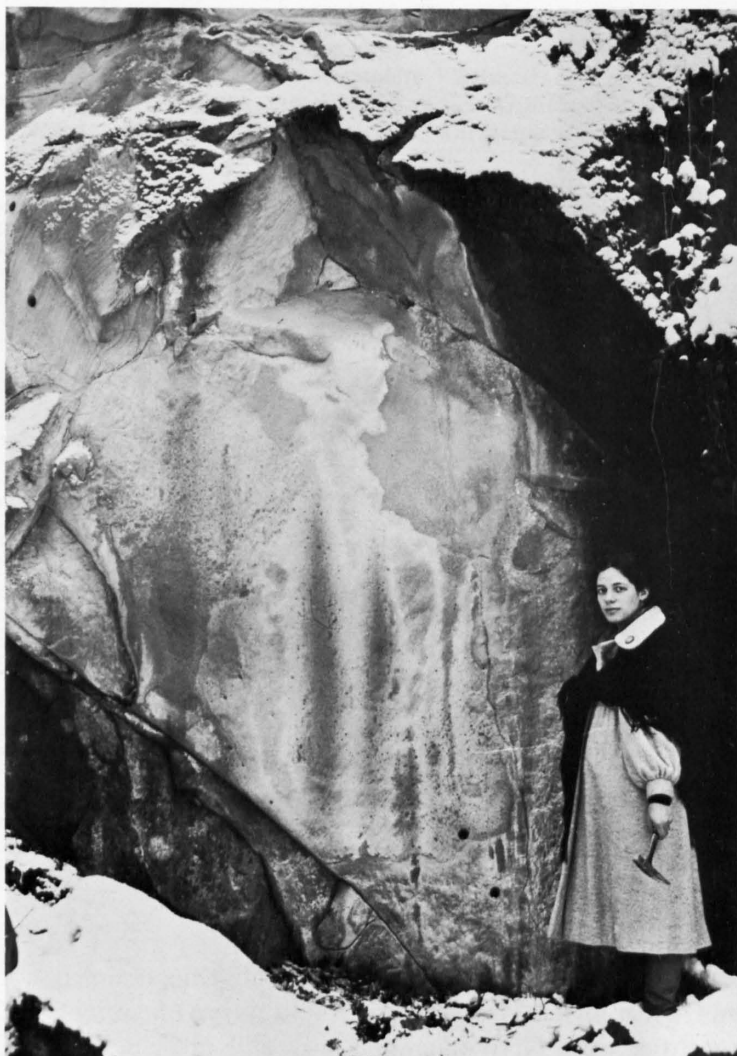
Fig. 42: Chatzenrietli. Regengeschützter Bereich (hell) mit Ausblühungen bedeckt und stark absandend. Beregnete und tropfwasserbenetzte Stellen (z.Z. schneebedeckt) sind algenbewachsen und oberflächlich intakt. 3.1.80.
