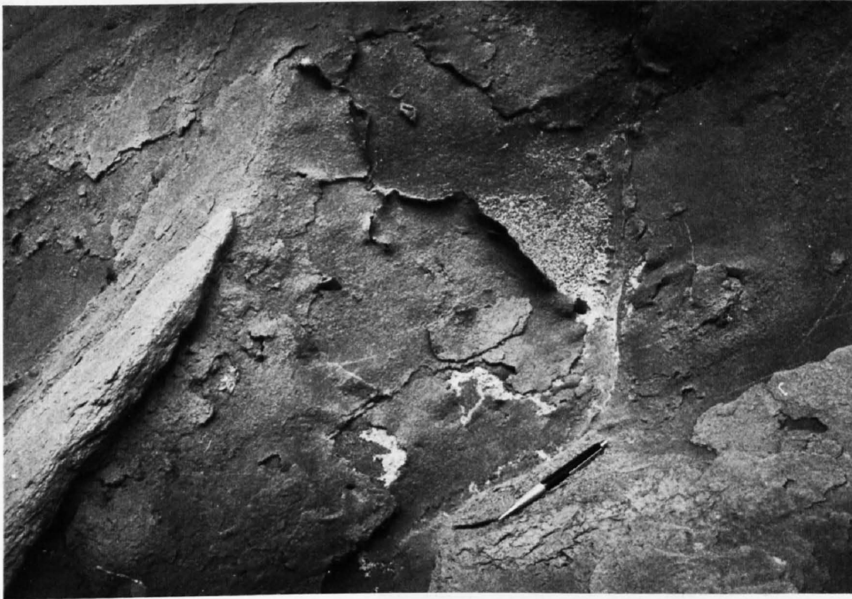
Fig. 33: Abblätternde Felsoberfläche (Martinsbrugg). Unter den sich abrollenden Blättern ist sie mit Magnesiumsulfat-Ausblühungen bedeckt. Im Zentrum Probenahmestelle B 11A. Die etwas hellere (ausgetrocknete) Rippe links bleibt in gelockertem Zustand erhalten (Probenahmestelle B 11B). 22.11.78.
