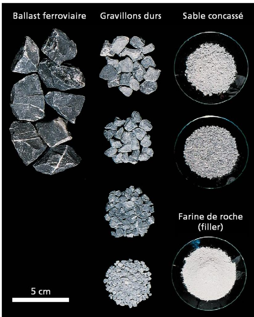
**Fig. 6:** Différentes fractions de granulats durs classées par granulométrie. Source de la photo: [19], modifié.
